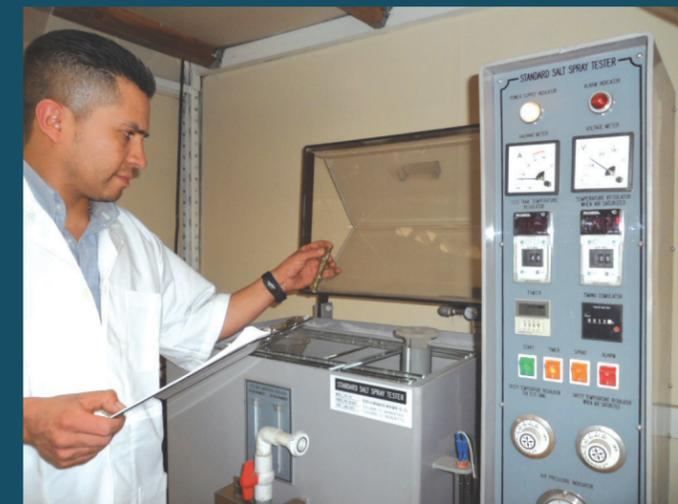
Probamos la resistencia a la corrosión en Cámara Salina.
