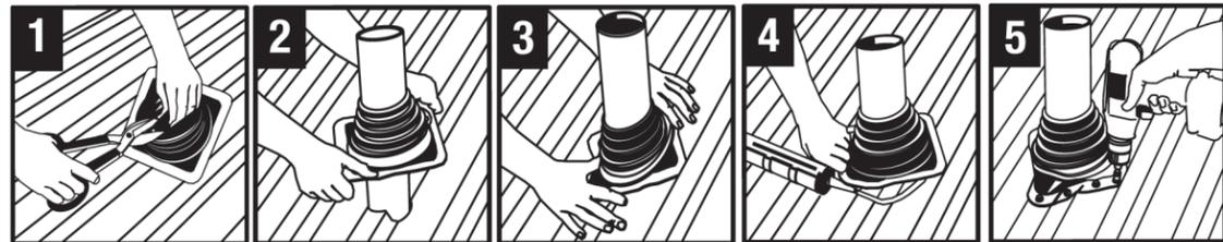
1 Elija la abertura y corte 2 Deslice sobre la tubería 3 Amolde al techo 4 Aplique Sellador 5 Atornille para terminar
