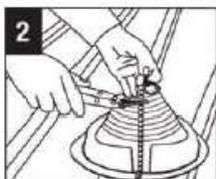
Utilizando las pinzas corte el sellador a la medida del tubo, empezando al contrario de la unión de cierre metálico.
