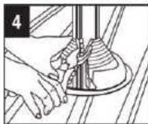
Presiona la unión fuertemente con las pinzas para plisar, empieza de arriba hacia debajo de la base.
